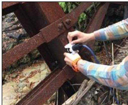
各種鉄鋼構造物の腐食による減肉を
