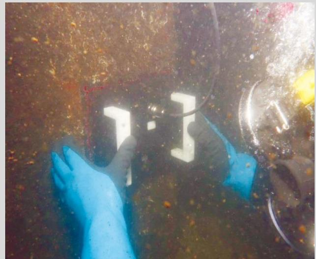
鉄鋼等の金属構造物の内部や裏面までも検査できる新しい検査器です。
